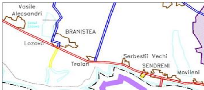
Figura 5-4 Sistemul de alimentare cu apă UAT Braniștea
